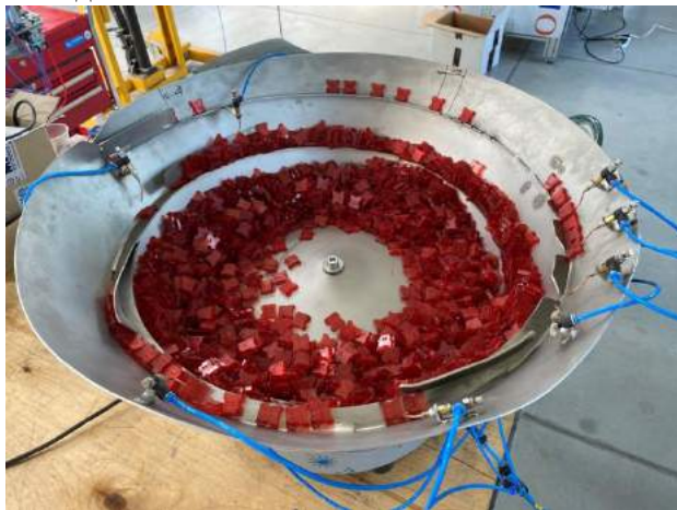
Фиг. 3. Изработка на виброчиния
